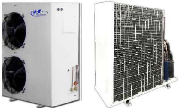
محل نصب کندانسینگ یونیت و تابلوی اصلی موتور خانه را بطور مداوم تمیز و پاکیزه نگه دارید. همواره قسمتهای مختلف کوئل کندانسورها، اتصالات و زانوی مسی و کندانسینگ یونیت را بدقت بازدید کنید، وجود لکه روغن در این نقاط نشان از وجود نشت گاز مبرد می باشد پس از نظافت کامل نسبت به رفع نشتشی یگاز مبرد اقدام کنید. انجام عمل شارژ باید توسط افراد آموزش دیده صورت گیرد.
